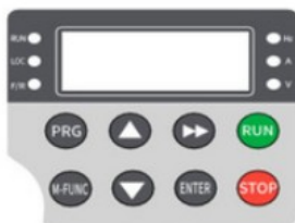
Figura 3-1 Diagrama Esquemático do Painel de Operação
